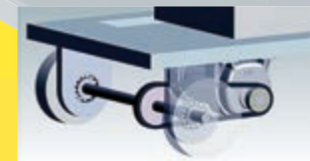
可連結鏈條 + 鏈輪，調整裝置整體的速度。(平行軸)
